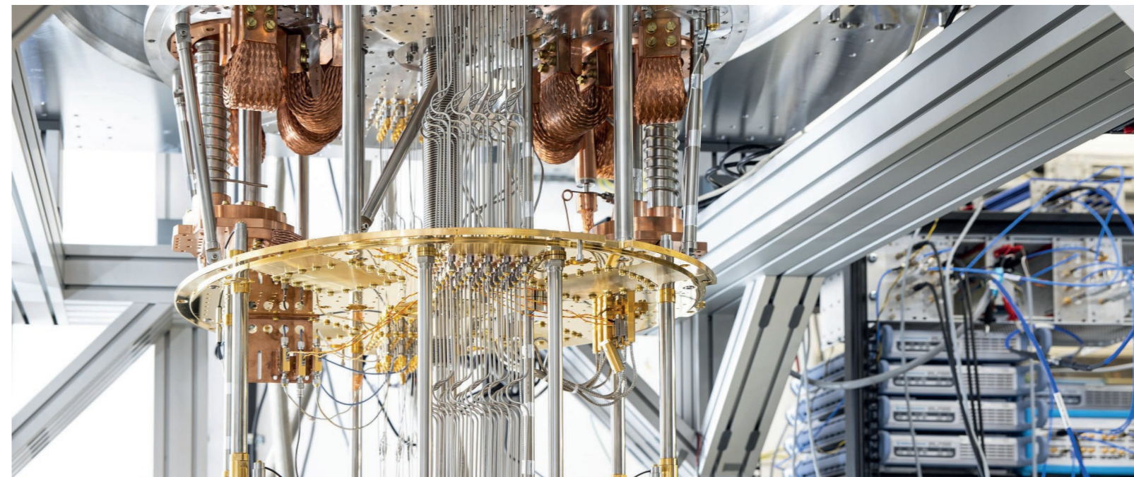
Kryostat eines Quantencomputers, der am Forschungszentrum Jülich aufgebaut wird. Forschungszentrum Jülich / Sascha Kreklau
